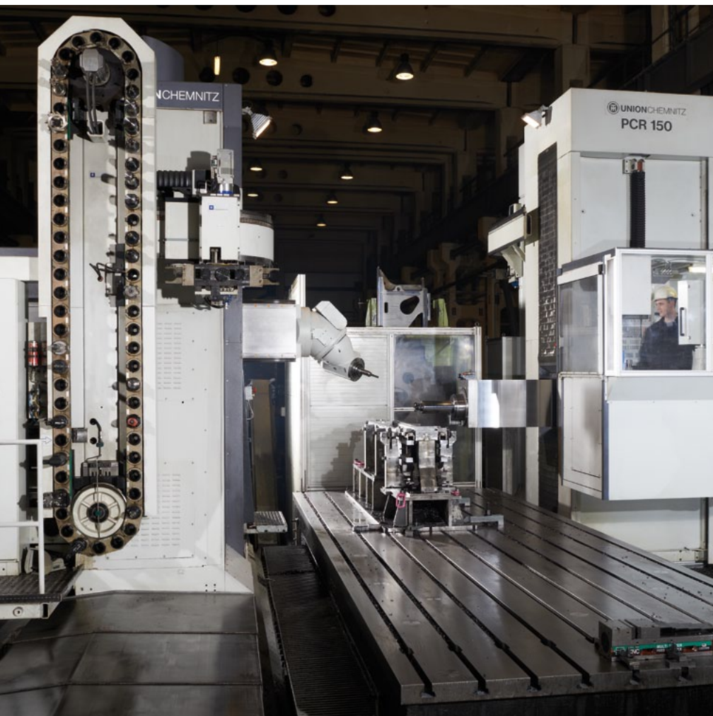
一台MILLFORCE 1和一台 PCR 150，实现对工件的对头加工
